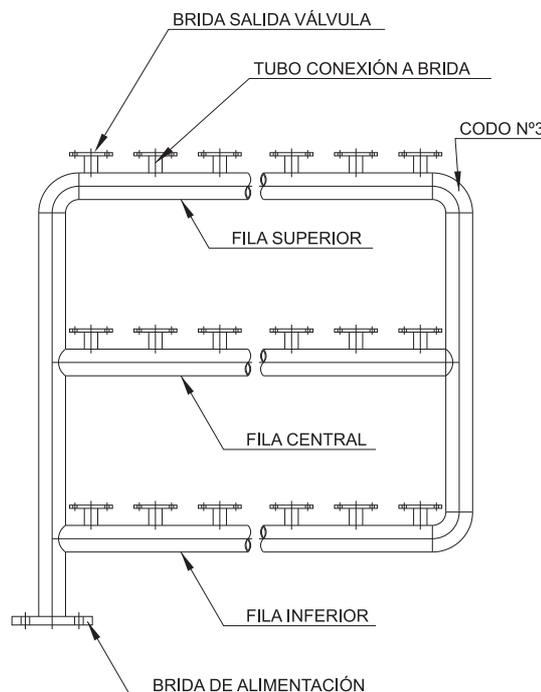
**MEDIDAS BATERÍAS A/G CIRCUITO CERRADO 2 FILAS - Cotas en mm**
