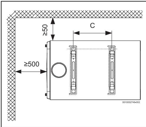
Fig. 3 Dimensões em mm (montagem mural, instalação horizontal)
