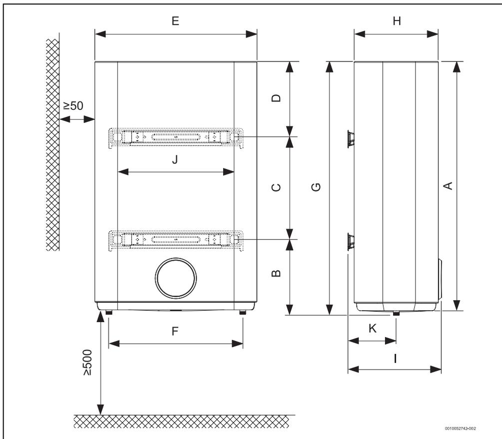
Fig. 2 Dimensões em mm (montagem mural, instalação vertical)
