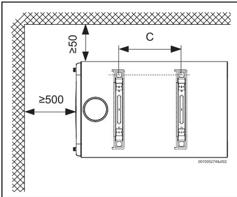
Fig. 3 Dimensões em mm (montagem mural, instalação horizontal)
