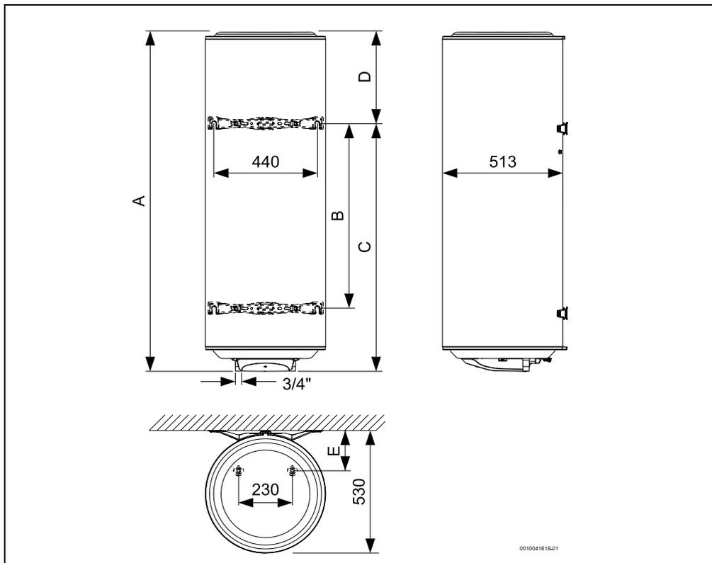
Fig. 2 Dimensões em mm (montagem mural, instalação vertical)
