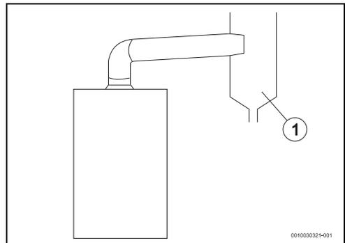
Fig. 13 Recolha de condensados
