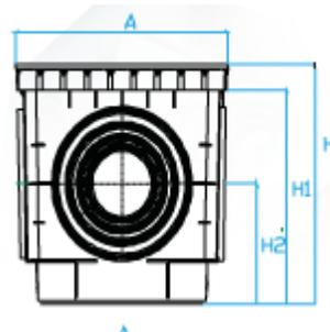
Quando necessário, para aumentar a altura/profundidade, as caixas são encastráveis, bastando para tal dar uma pancada seca a meio de fora para dentro no fundo de uma.
