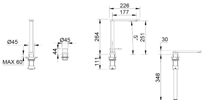
Altura da misturadora máx. 264mm / min. 44mm
