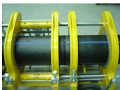
**União térmica com soldadura topo a topo**
