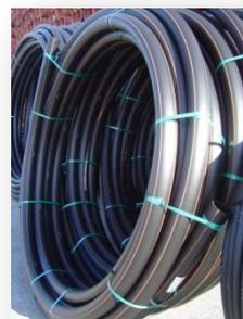
O armazenamento sob luz solar direta por longos períodos e/ou altas temperaturas pode causar deformações diamétricas (ovalizações) que podem afectar os processos de soldadura. Para evitar esse risco, as seguintes precauções são recomendadas:
