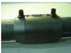
União entre um tubo de PE100 Preto com Lista Azul EN 12201 W e um acessório electrosoldável com embocadura ou com sela. Os acessórios electrosoldáveis são aquecidos por efeito de Joule (uma carga eléctrica de baixa voltagem (cerca de 45volt) aplicada na bobine de fio de cobre incorporada na superfície da zona de contacto do acessório), provocando a fusão do material de ambas as superfícies em contacto (tubo e acessório).
