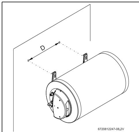
Fig. 8 Instalação na horizontal (montagem mural)
