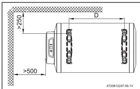
Fig. 3 Dimensões em mm (montagem mural, Instalação horizontal)
