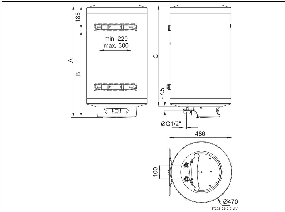
Fig. 2 Dimensões em mm (montagem mural, instalação vertical)
