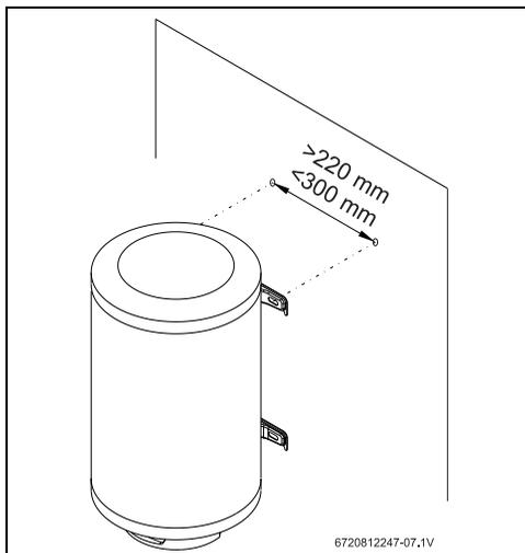
Fig. 7 Instalação na vertical (montagem mural)
