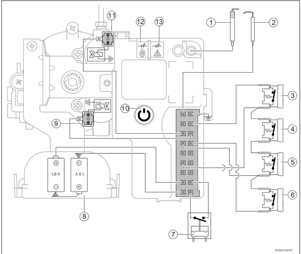
Fig. 25 Esquema elétrico
