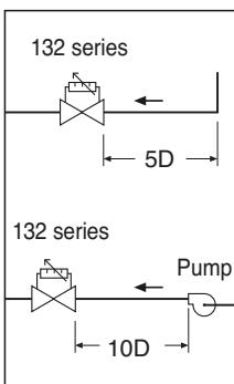
L'installazione delle valvole di bilanciamento con flussometro incorporato deve essere eseguita da parte di personale tecnico qualificato secondo le indicazioni riportate nel presente manuale ed in accordo alla normativa vigente.
