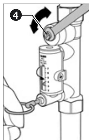
C. Houdt de afsluitnaald open en regel tegelijkertijd het debiet in met behulp van een stelsleutel (9 mm voor 1/2" en 1 1/4" en 12 mm voor 1 1/2" en 2"). Het debiet wordt aangegeven door een metalen kogel (5), die binnenin een transparante cilinder (6) loopt met daarlangs een schaal in l/min.
