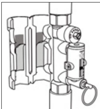
2. Se la valvola di bilanciamento con flussometro viene utilizzata con acqua refrigerata, stendere sul bordo esterno della coibentazione un leggero strato di sigillante, attendere che il solvente sia evaporato (~10 minuti) e richiudere.
