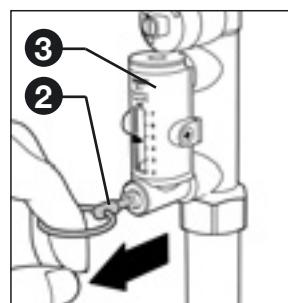
C. Mantenendo aperto l'otturatore, agire con una chiave di manovra (da 9 mm per misure da 1/2" a 1 1/4"; 12 mm per misure da 1 1/2" e 2") sull'asta di comando della valvola (4) per effettuare la regolazione della portata. Essa viene indicata da una sfera metallica (5), che scorre all'interno di una guida trasparente (6) a lato della quale è riportata una scala graduata di lettura espressa in l/min.
