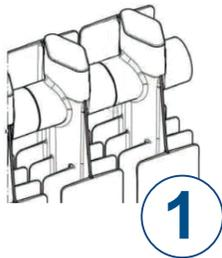
Colocar el emisor en posición invertida con la parte superior apoyada en el suelo.
