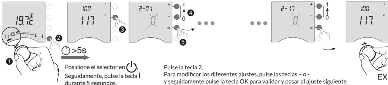
Posicione el selector en . Seguidamente, pulse la tecla **i** durante 5 segundos.
