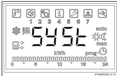
Fig. 20 Sistema auxiliar ativo
