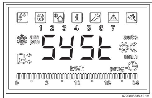
Fig. 27 Sistema de apoio auxiliar em operação
