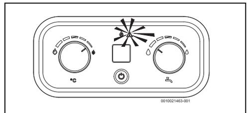
Fig. 5 Substituir as baterias
