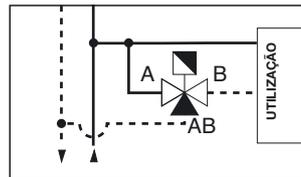
2. A válvula deve ser instalada com a haste de comando na posição horizontal ou vertical, **mas nunca virada ao contrário.**
