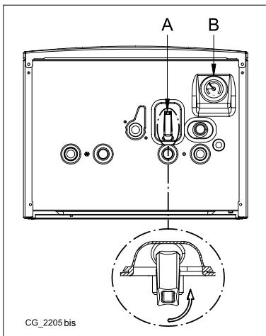
**! La caldera está dotada de un presóstato hidráulico que no permite el funcionamiento de la caldera en caso de falta de agua.**
