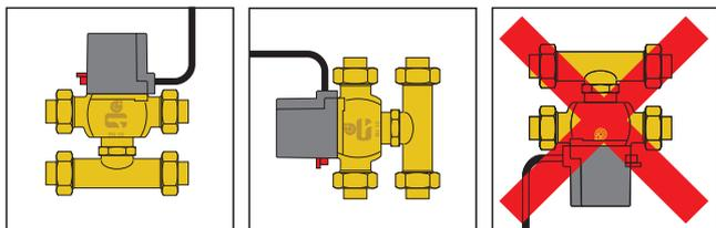
4. Il comando elettrotermico serie 630 può essere montato, tramite le due viti a corredo, sulla valvola già collegata alle tubazioni sia con il cavo elettrico di collegamento rivolto verso il basso che verso l'alto.
