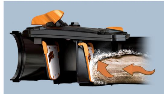
Cuando la acometida se ve sometida a caudales que ocasionan el llenado de la misma y este sobrecarga tiende a penetrar en sentido contrario al habitual, actúa la clapeta de la válvula anti-retorno, impidiendo su entrada al interior de la vivienda.
