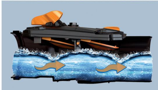
El agua de saneamiento fluirá a través de la válvula anti-retorno empujando en sentido del flujo las clapetas internas, en dirección a la salida (parte macho) de la válvula.
