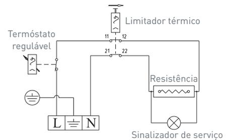
ESQUEMA DE MONTAGEM DO TERMOACUMULADOR
