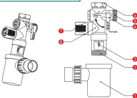
1. Copo de esgoto sifonado; 2. Ligaçãõ roscada para copo de esgoto; 3. Guia de água para descarga; 4. Passador de corte ao termoacumulador. Para abrir, rode para a direita meia volta; 5. Entrada de água da rede, válvula anti-retorno; 6. Entrada de água fria para o termoacumulador; 7. Comando de descarga / limpeza e esvaziamento do termoacumulador (rodar só para a esquerda); 8. Válvula de Segurança
