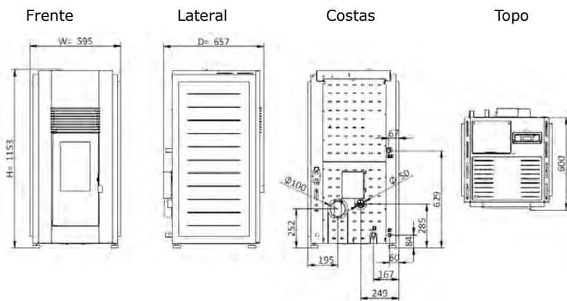
**Figura 3 - Dimensões da salamandra a pellets (Douro 17 kW)**
