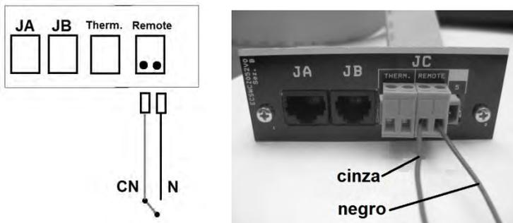
**Figura 28 - Ligações do comando externo com fios**
