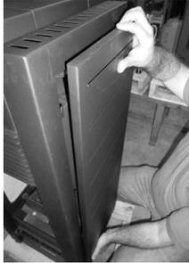
Figura 23 - Remoção das capas laterais
