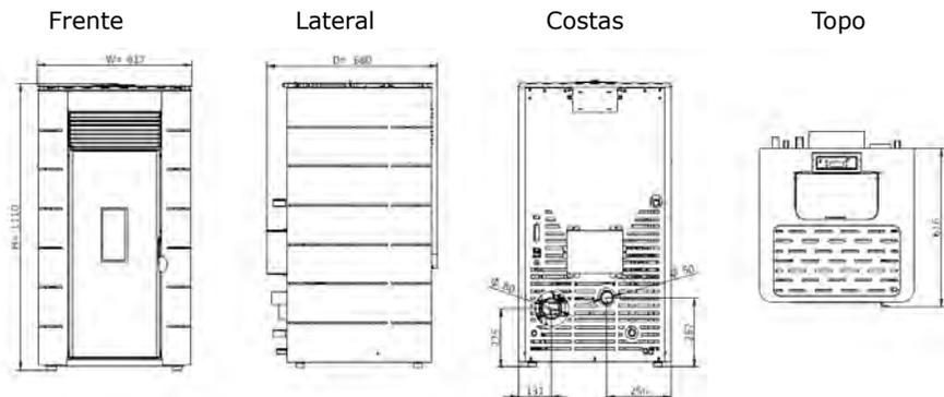
**Figura 2 - Dimensões da salamandra a pellets (Douro 12 kW)**
