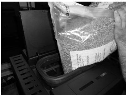
**Figura 25 - Reabastecimento do depósito de pellets**
