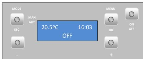
**Seleccionar modo de funcionamento:** para seleccionar o modo de funcionamento, carregamos na tecla "mode" para seleccionar modo manual "Manu" ou modo automático "Auto".
