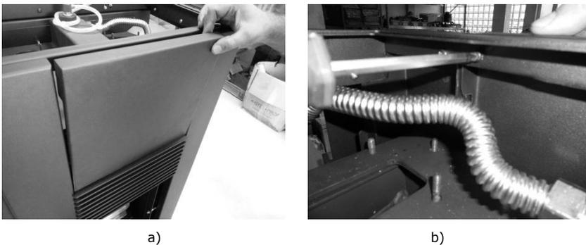
**Figura 13 - Montagem da capa frontal superior**
