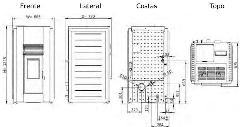
**Figura 4 - Dimensões da salamandra a pellets (Douro 23 kW)**
