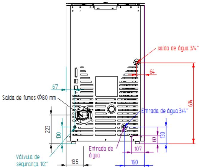
**Figura 5 – Ligações hidráulicas da salamandra a pellets (Douro 12 kW)**
