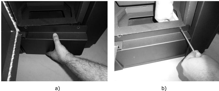
**Figura 14 - Montagem da capa frontal inferior**
