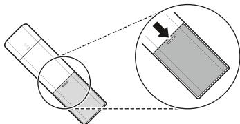
2 Insira as novas baterias e assegure-se de que os terminais + e - das baterias estão orientados corretamente.
