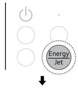
3 Quando a operação de arrefecimento começar, mantenha premido o botão **Energy/Jet** durante 3 segundos. A indicação **Indirect On** será apresentada, e não sairão ar da saída de ar na parte inferior do equipamento.
