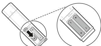
3 Volte a instalar a tampa deslizando-a novamente para posição.
