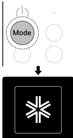
**3** Quando a operação de arrefecimento for iniciada, pressione repetidamente o botão **Energy/Jet** para selecionar o modo **Arrefecimento a Jato**. O ícone que representa o modo **Arrefecimento a Jato** é apresentado, e a operação de arrefecimento é iniciada no modo **Arrefecimento a Jato**.
