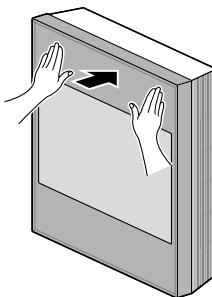
6 Fixe a estrutura inferior à parte inferior do painel frontal, e de seguida pressione ambas as extremidades da estrutura inferior com as mãos até encaixarem no lugar.
