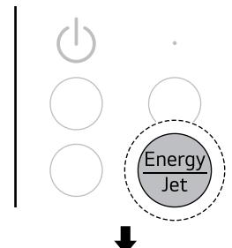
**3** Quando a operação de arrefecimento começar, mantenha premido o botão **Energy/Jet** durante 3 segundos. A indicação **Indirect On** será apresentada, e não sairão ar da saída de ar na parte inferior do equipamento.
