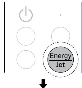
3 Quando a operação de aquecimento começar, mantenha premido o botão **Energy/Jet** durante 3 segundos. A indicação **Indirect On** será apresentada, e não sairá ar da saída de ar situada na parte inferior do equipamento.
