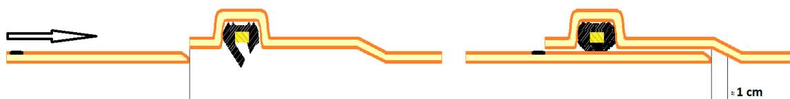
Figura 3 - União do tubo 3KKK Saneamento com o-ring labial reforçado
