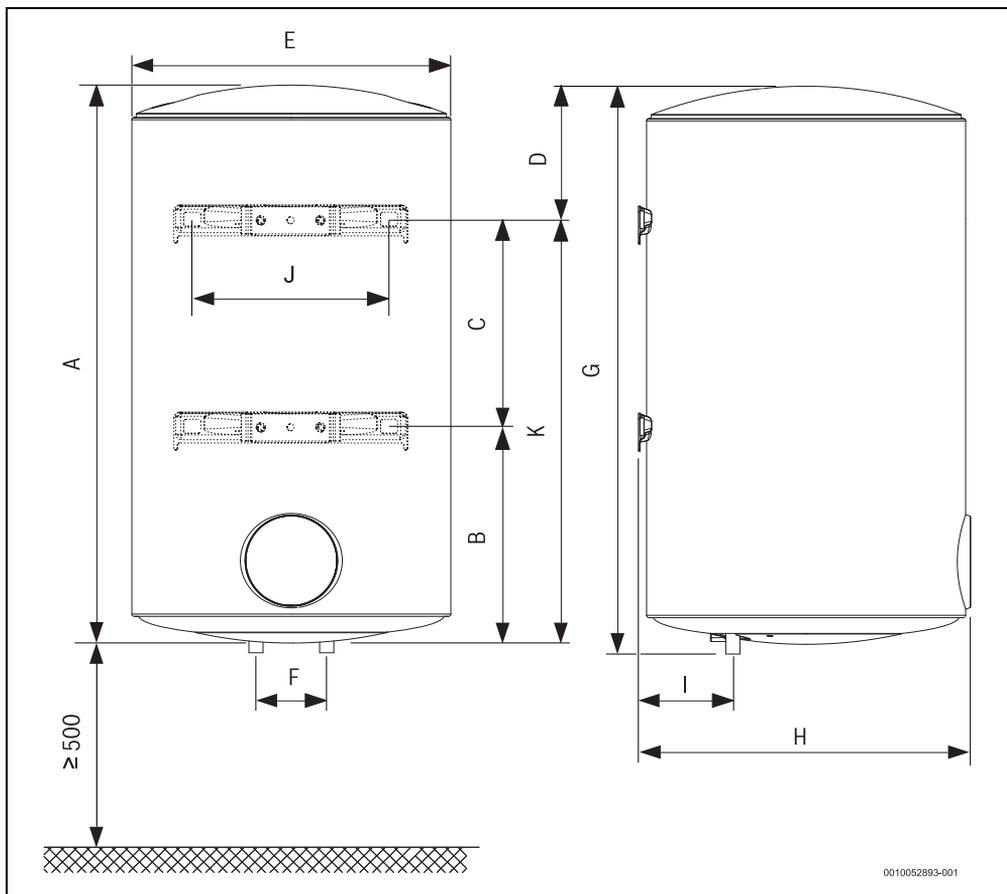
Fig. 2 Dimensões em mm (montagem mural, instalação vertical)
