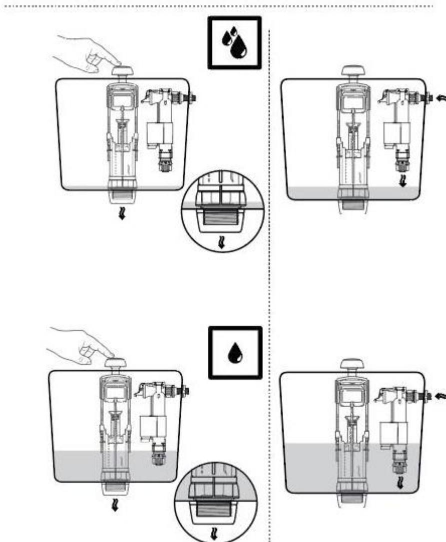
A torneira de bóia IVC100 PLUS com o sistema de abertura retardada, abrindo apenas depois da válvula de descarga fechar. Este sistema permite uma poupança média de água de cerca de 0.5 litros em cada descarga, resultando numa poupança média diária de cerca de 9 litros
